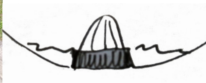
Skiss 2. En dagvattenbrunn kan förses med krage för att att en temporär vattenspegel ska åstadkommas.
