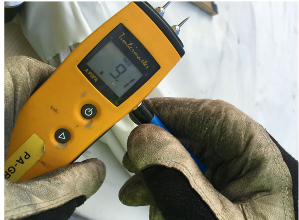
6. FK i KL-element 9,1% + ca 2% temperaturkorrigering pga utetemperatur
